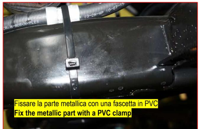
Fissare la parte metallica con una fascetta in PVC
